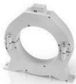
Toroidi a nucleo chiuso (-C) oppure a nucleo aperto (-A) per essere inseriti senza interrompere il circuito primario dell'impianto. Sono costituiti da un nucleo magnetico e utilizzati su relè differenziale permettendo di rilevare correnti di guasto di valore anche molto basso.
